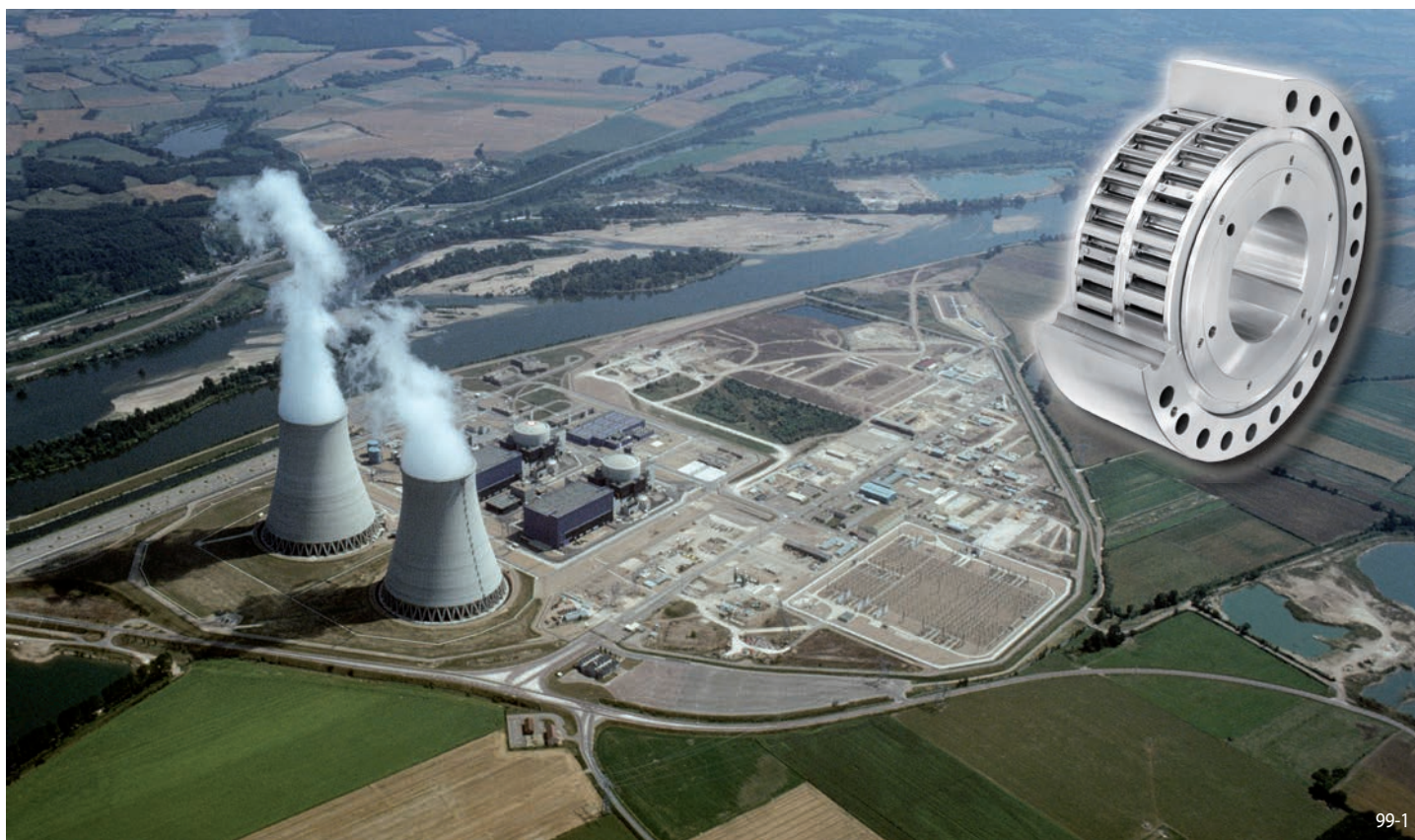
Antidévireur FXM 2.410-100 LX, couple maximum 500 000 Nm, vitesse 1 485 min -1 , pour la pompe de refroidissement primaire d'une centrale nucléaire. En service depuis 1996. Fabriqué et testé sur la base d'une étude entièrement réalisée par RINGSPANN GmbH, Bad Homburg.
